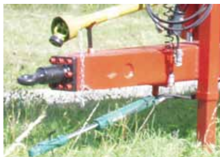
Essieu suiveur forcé avec avec commande hydropneumatique et attelage tournant type Scharmüller.
